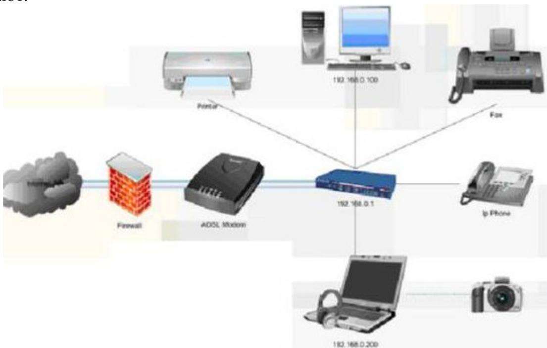
Рисунок 4. Схема сети небольшого офиса
