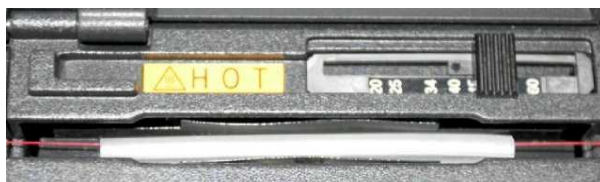
Защита сварного соединения при помощи гильзы КДЗС (Комплект дополнительной защиты соединения)
