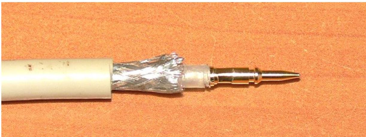
Рисунок 3. Коаксиальный кабель RG-58 после установки и обжима центрального контакта
