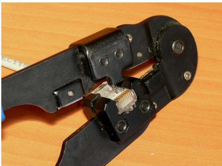
Рисунок 9. Коннектор RJ-45 в обжимном инструменте
