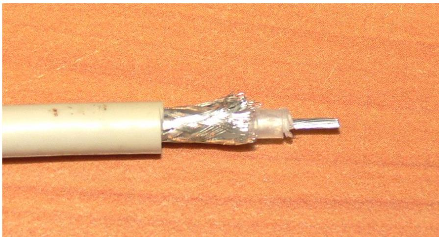
Рисунок 2. Коаксиальный кабель RG-58 после зачистки
