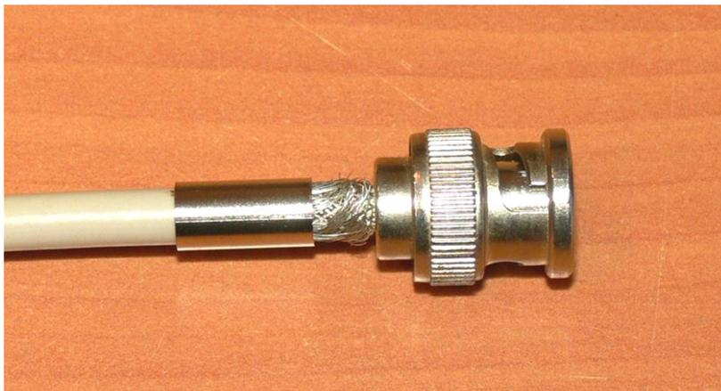
Рисунок 4. Коаксиальный кабель с установленной основной частью коннектора и не полностью надетой обжимной трубочкой
