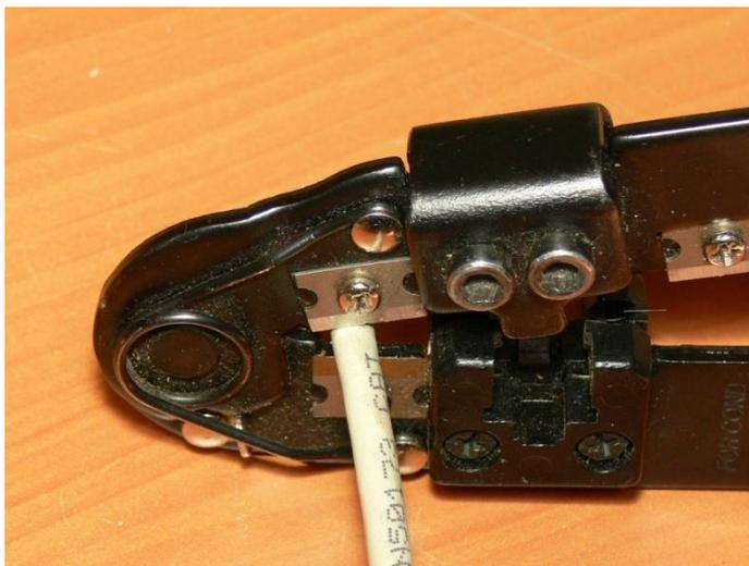
Рисунок 6. Обрезка внешней изоляции на кабеле «витая пара»
