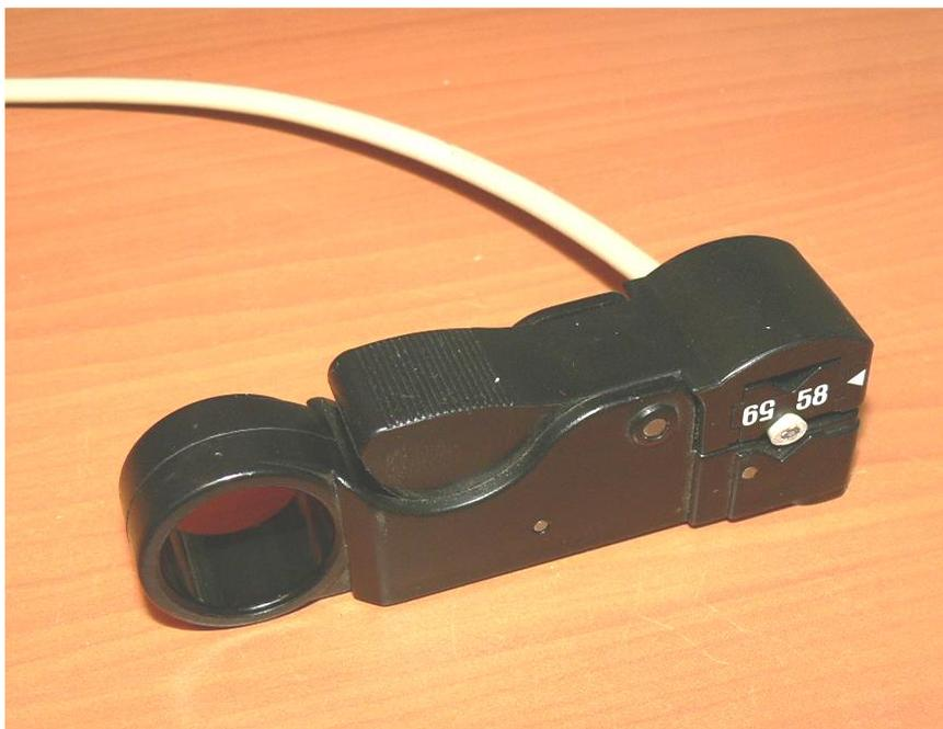
Рисунок 1. Коаксиальный кабель RG-58 в устройстве для его зачистки
