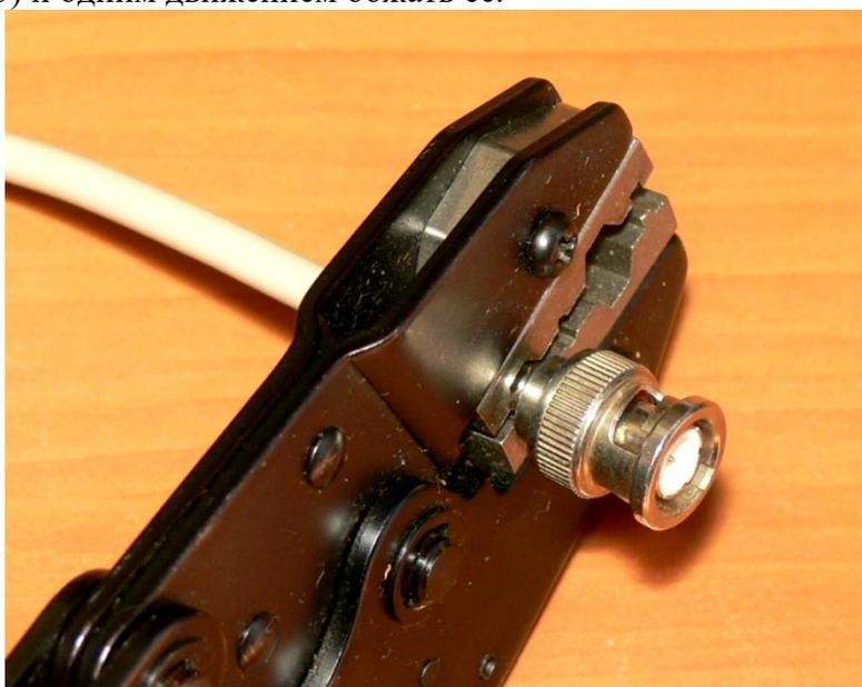
Рисунок 5. Коннектор BNC в обжимном инструменте
