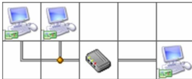
Соединение ПК посредством прямого кабеля (серого цвета)
