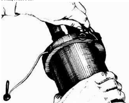
Рисунок 4.16 – Стягивание хомута и фиксация его защелкой
