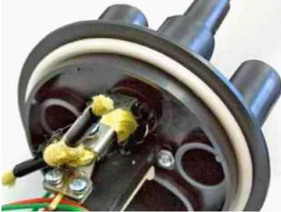
Рисунок 4.4 – Крепление синтетических (арамидных) нитей
