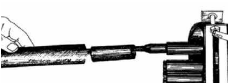
Рисунок 4.5 – Последовательность расположения ТУТ
