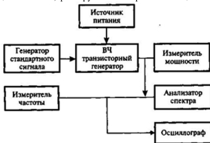
Рис. 2. Измерительная аппаратура для регулировки ВЧ транзисторного генератора с внешним возбуждением
