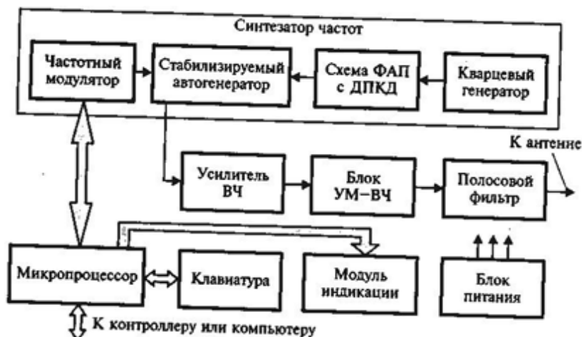
Рис. 3. Структурная схема передатчика мощностью до 50 Вт
