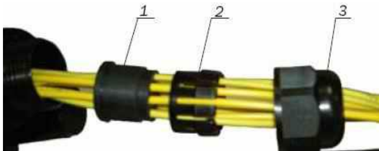
Рисунок 4.14 - Установка ввода кабельного MG 25A на ШОС 1 – Уплотнитель; 2 – Втулка цанговая; 3 – Гайка накидная
