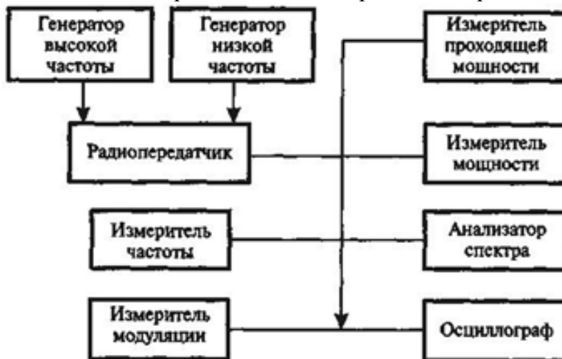
Рис. 1. Обобщенная структурная схема стенда по измерению параметров радиопередатчиков малой и средней мощности
