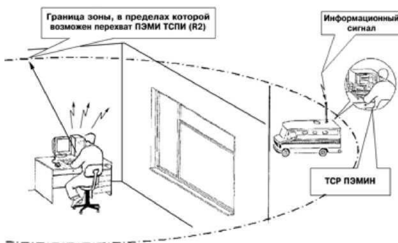
Рис. 1.2. Перехват побочных электромагнитных излучений ТСПИ средствами разведки ПЭМИН
