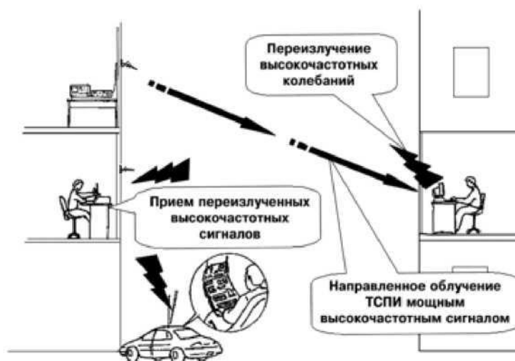
Рис. 1.3. Перехват информации, обрабатываемой ТСПИ, методом “высокочастотного облучения”
