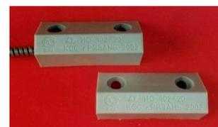
Извещатель конструктивно состоит из магнитоуправляемого датчика (геркон, помещенный в пластмассовый или металлический корпус) и управляющего магнита (магнит, установленный в пластмассовый или металлический корпус). Конструкция извещателя обеспечивает степень защиты оболочки IP 44 по ГОСТ 14254.
