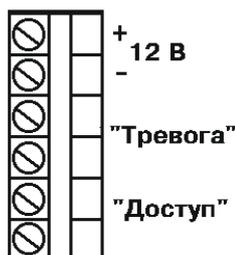
Рисунок 3. Клеммы подключения
