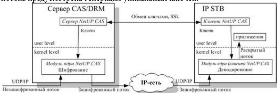
Абонентское устройство устанавливает защищенное соединение с сервером системы сокрытия и периодически получает обновленные ключи шифрования. Полученные ключи передаются в модуль ядра Linux на абонентском устройстве. Данный модуль перехватывает IP-пакеты, получаемые из сети, и производит их дешифрование, если поток зашифрован и имеются в наличии
