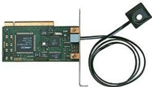
Представляют собой аппаратный контроллер, предназначенный для установки в слот ISA (модификация 4.5) или PCI (модификация 5.0). Модули «Аккорд-АМДЗ» обеспечивают доверенную загрузку операционных систем любого типа с файловой структурой FAT12, FAT16, FAT32, NTFS, HPFS, Free BSD, Linux EXT2FS.
