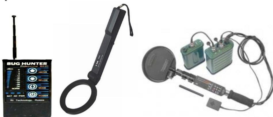
Самые простые и распространённые средства поиска – это **детекторы поля** и **поисковые широкополосные и сканирующие приемники с захватом частоты**. Такие устройства позволяют выявить наличие радио сигнала и определить место излучения по максимальному уровню излучаемого сигнала. Сканирующий приемник ищет наличие излучения в нескольких определённых диапазонах.
