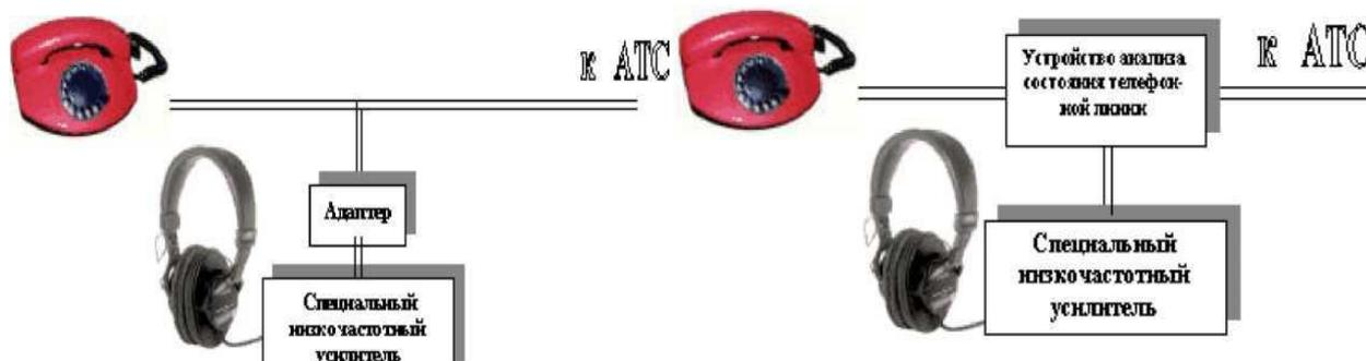
Рис. 1 Схема подключения специальных низкочастотных усилителей к телефонной линии через адаптер
