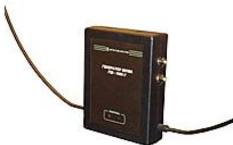
Предназначен для маскировки побочных информативных электромагнитных излучений и наводок персональных компьютеров, компьютерных сетей и комплексов на объектах вычислительной техники 1, 2 и 3 категорий в диапазоне частот 0,1-1800 МГц путем формирования и излучения в окружающее пространство маскирующего электромагнитного поля шума (ЭМПШ). Дополнительно имеет 4 независимых коаксиальных выхода некоррелированного напряжения шума, к которым можно подключать:
