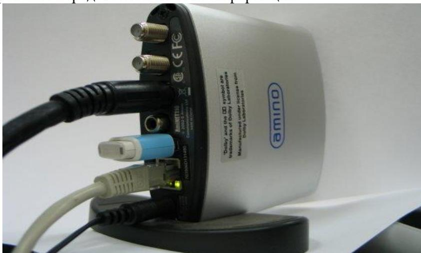
Рисунок. Абонентское устройство IP STB Amino 110 с установленным USB-носителем:
