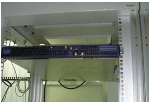
Рисунок 4 Внешний вид системы IDS 4210 CiscoSystems, установленной в стойку.
