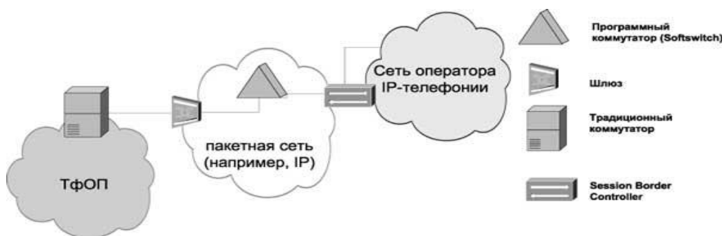
Рисунок 1. Традиционная схема взаимодействия сетей традиционной телефонии и NGN
