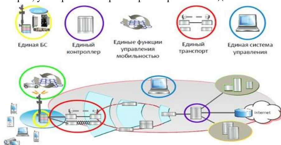
Рисунок– Конвергентная подсистема радиодоступа
