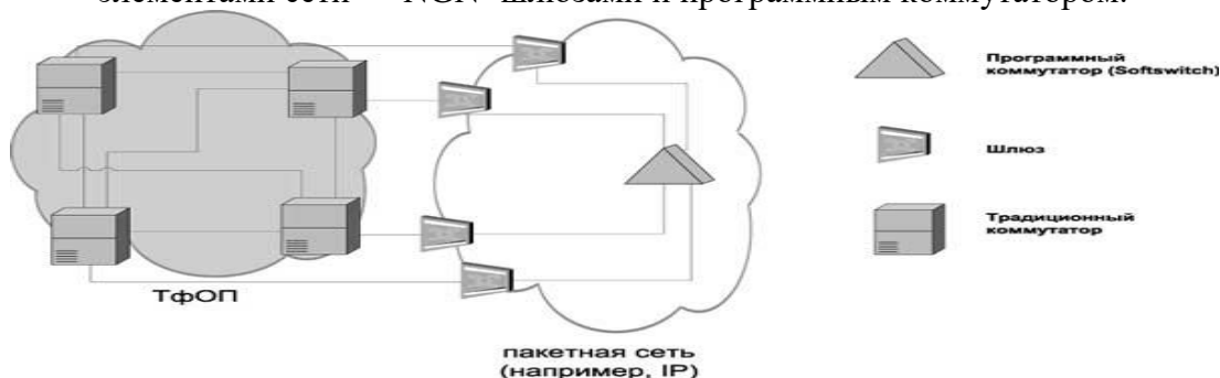
Рисунок 2. Пакетная сеть, резервирующая по нагрузке основную телефонную сеть.
