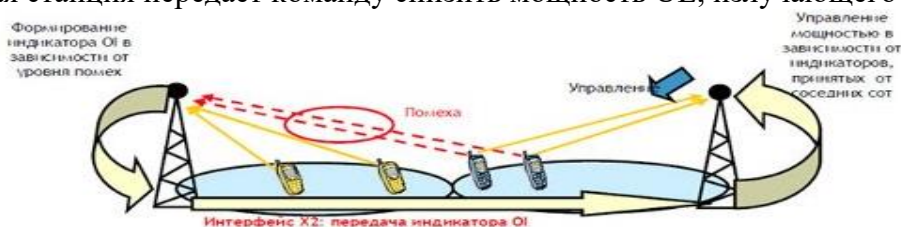
Рисунок – Управление мощностью соседней базовой станции
