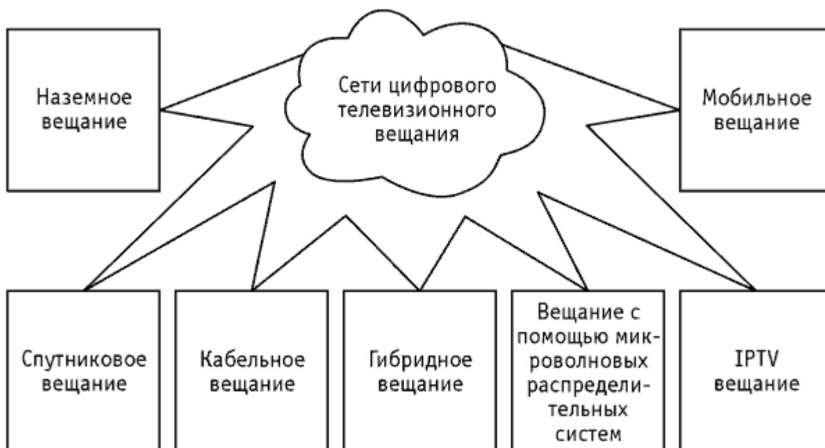
**Рисунок. Функциональная схема классификации мультисервисных сетей цифрового телевизионного вещания**
