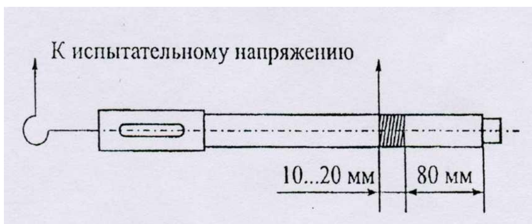
Схема подключения напряжения при испытании рабочей части и определении напряжения зажигания указателя УВНИ-10
