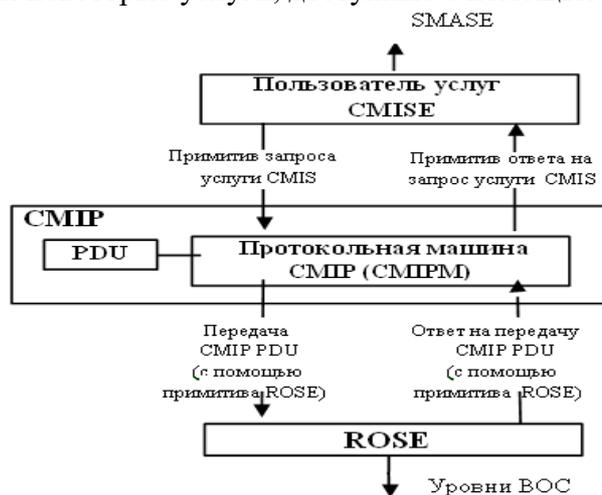
Рисунок. Структура протокольной машины CMIPM
