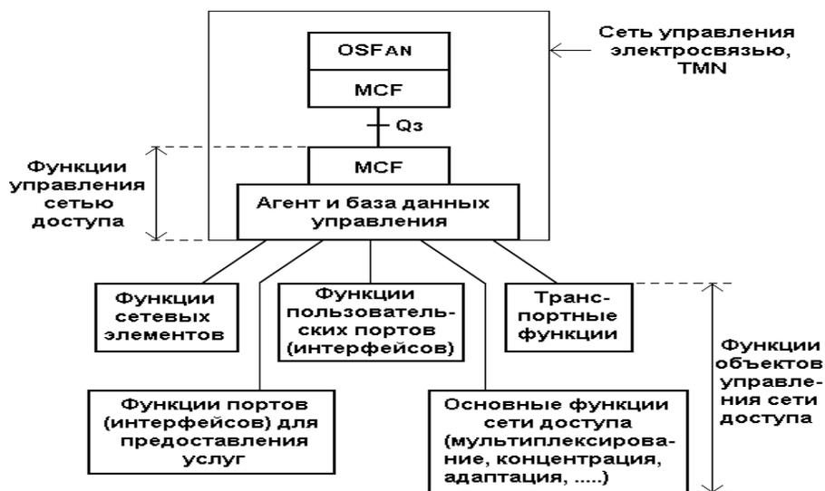
Рисунок Общая функциональная архитектура управления сетью доступа
