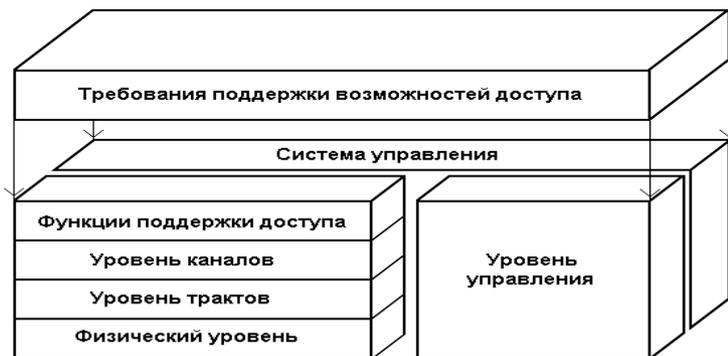
Рисунок Структура модели протоколов сети доступа
