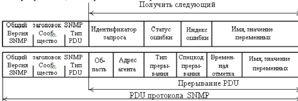
Рисунок. Форматы блоков PDU в SNMP (v1 и v2)
