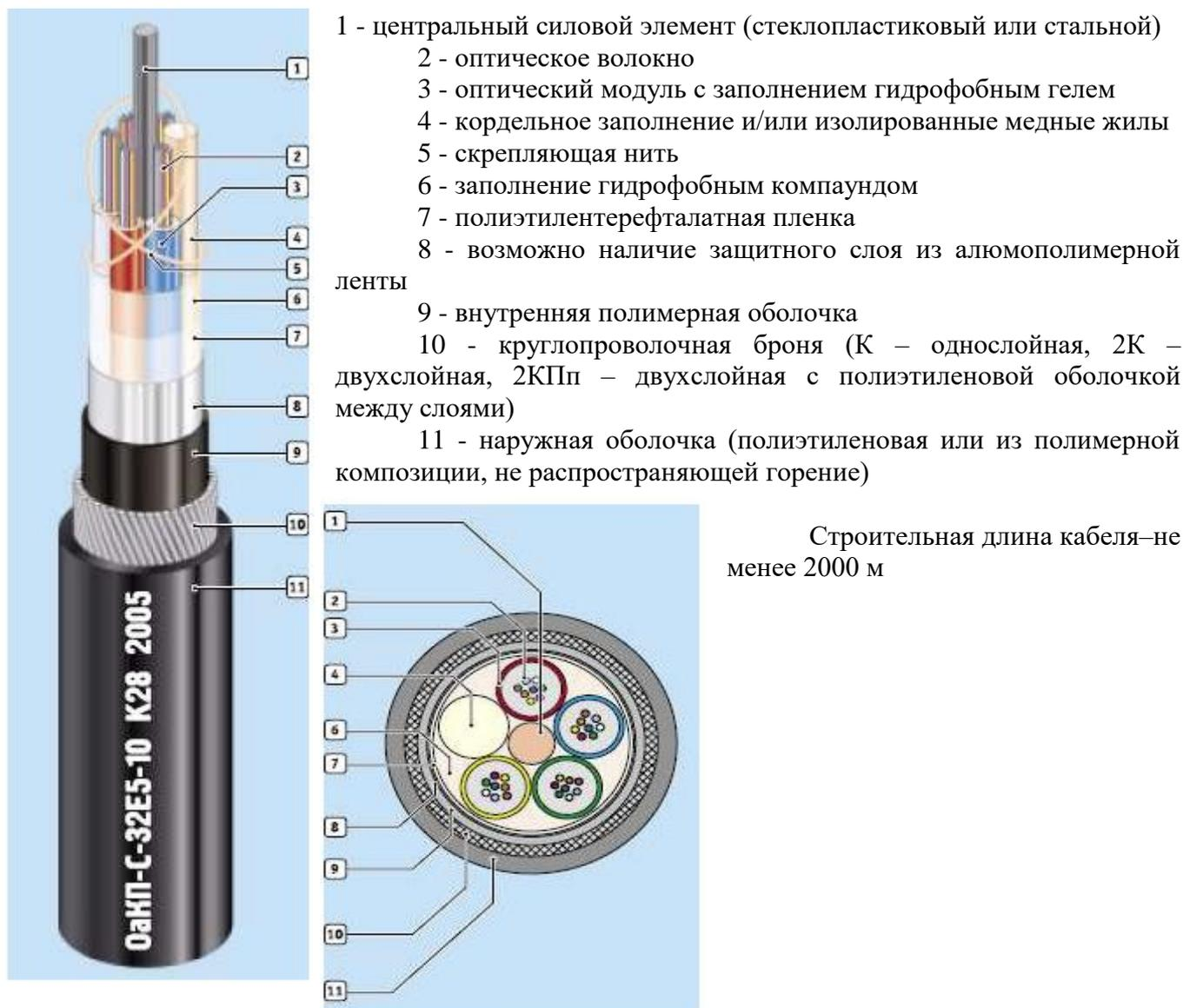
Рисунок 9 Конструкция кабеля типа ОКП
