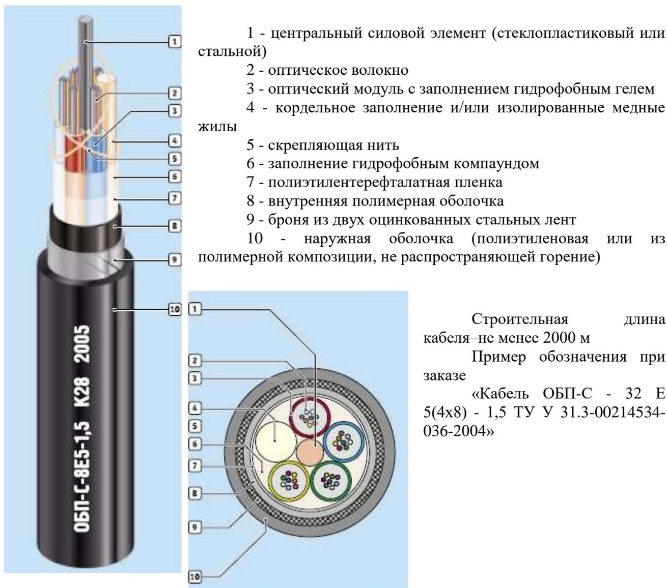
Рисунок 8 Конструкция кабеля типа ОБП-С
