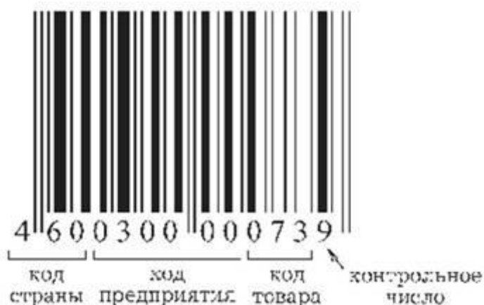
Рис. 1. Код EAN-13. Внешний вид и структура.
