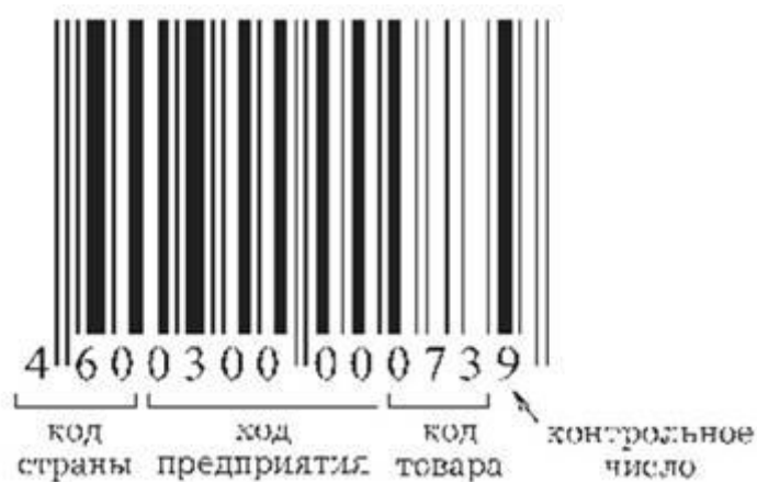
Рис. 1. Код EAN-13. Внешний вид и структура.
