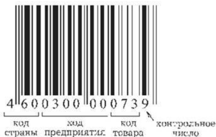
Рис. 1. Код EAN-13. Внешний вид и структура.
