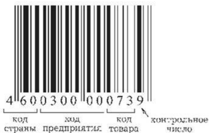
Рис. 1. Код EAN-13. Внешний вид и структура.
