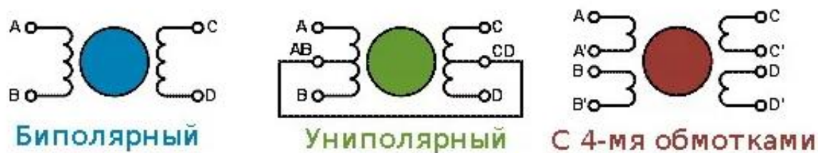
Рисунок 3. Типы шаговых двигателей по виду обмоток
