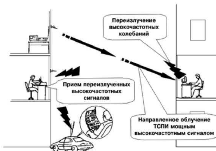
Рис. 1.3. Перехват информации, обрабатываемой ТСПИ, методом “высокочастотного облучения”
