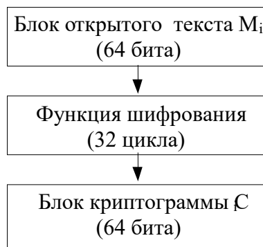
Рисунок 1. Схема алгоритма ГОСТ в режиме простой замены
