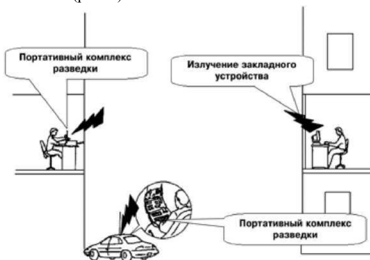
Рис. 1.4. Перехват информации, обрабатываемой ТСПИ, путем установки в них закладных устройств
