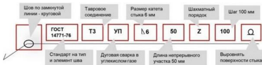
Рис. 6.4 – Структура расположения маркировочных знаков
