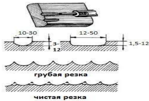
Рисунок 2.1 – Поверхностная резка и формы выплавляемых канавок
