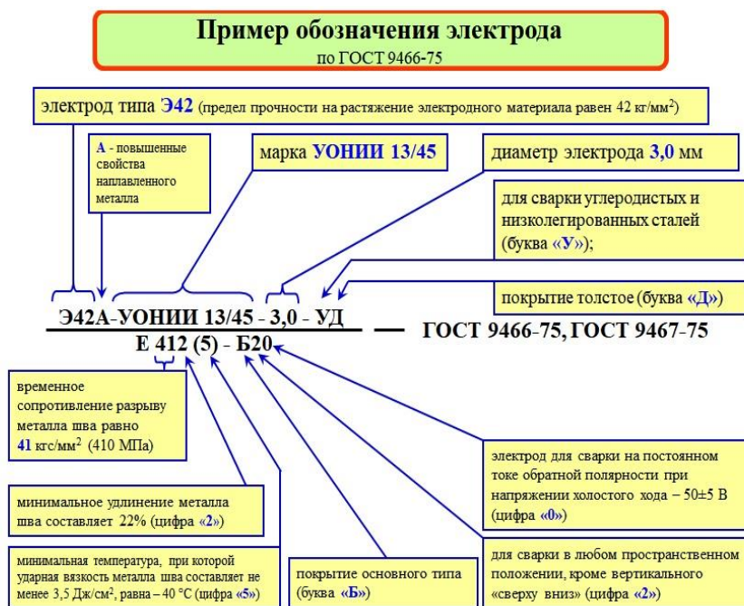
Рисунок 5.1 – Структура и пример условного обозначения электрода
