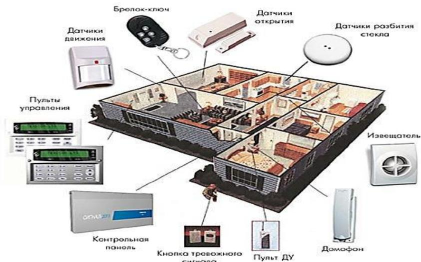
**Системы контроля доступа (СКУД)** применяются для ограничения и разрешения перемещения персонала и посетителей в помещениях, зданиях и на территории охраняемого объекта. Основа системы контроля доступа - считывание уникальных кодов с идентификаторов и их сравнении с данными в памяти запрограммированной системы.
