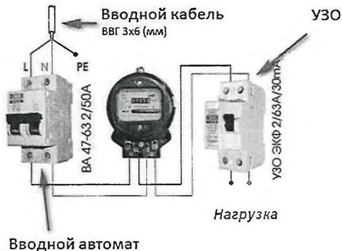
Рисунок 1. Схема подключения четырехконтактного УЗО (однофазное).
